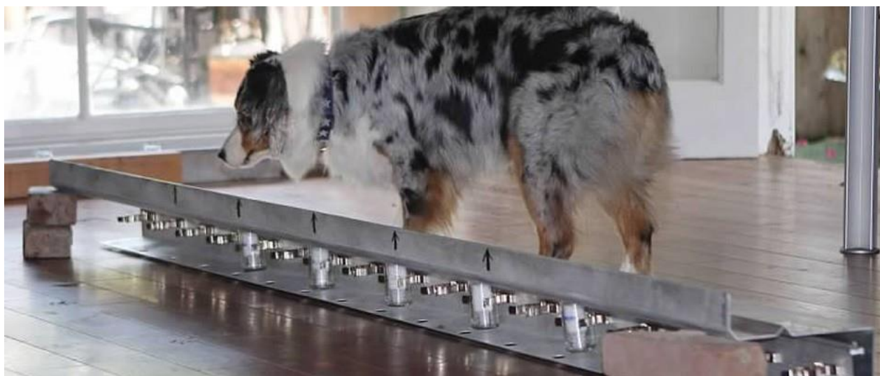
Ryc. 2. Przykładowy zestaw służący do testów dla psów podczas treningu detekcji węchowej. Pies ma za zadanie w wyuczony wcześniej sposób zasygnalizować obecność poszukiwanej substancji w wybranej próbce. Źródło: http://dogsdetectcancer.org
